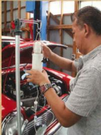
進化系は写真のような点滴を使ってエンジン内部に注入する。オイルレベルゲージの穴に点滴を入れ、エンジンをまわしながら注入する。
